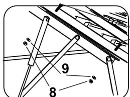
**ВНИМАНИЕ!** Газлифт крепится на подъемный механизм цилиндром вверх как на схеме.
